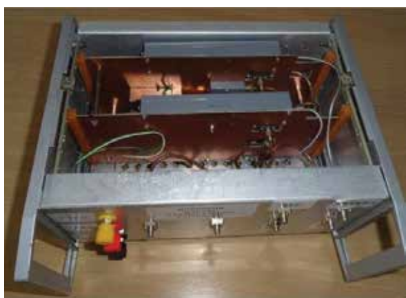
Odbiornik Front-End radaru szumowego z korelatorem cyfrowym
