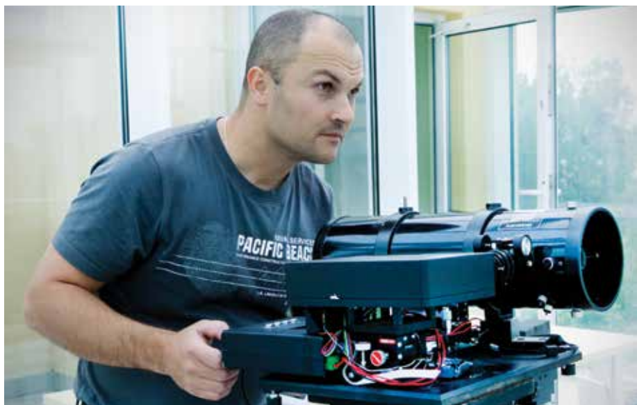
Dr inż. Jarosław Młyńczak z IOEWAT testuje fluorescencyjny lidar krótkiego zasięgu do detekcji materiałów biologicznych
